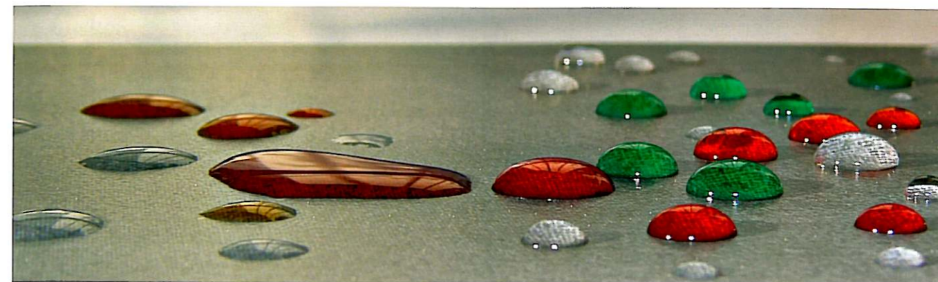
Bildet viser hvordan dråpene på venstre side flyter ut, og dekker et større område av flisen. Høyre side er nanobehandlet og viser hvordan dråpene perler og har minimal kontakt med overflaten. Dermed vil dråpene lettere renne av, overflaten tørke opp, og forbli ren.
